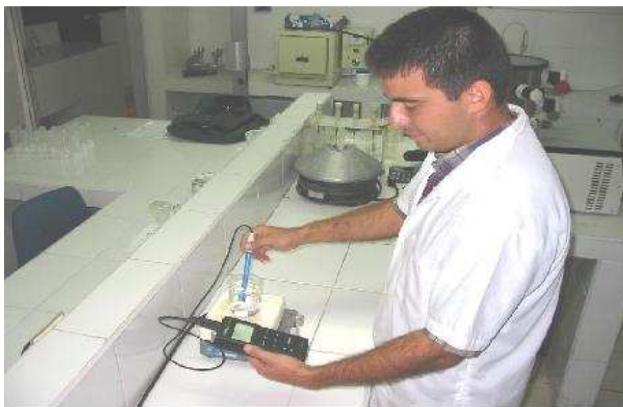
Equipo pHmetro WTW. Utilizado para medir el pH en laboratorio y en campo
