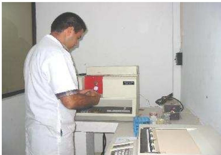
Cromatógrafo de gases Perkin – Elmer Sigma 300 con detector FID, utilizado para la identificación y cuantificación de hidrocarburos alifáticos y aromáticos
