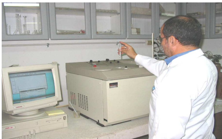
Cromatógrafo de gases Perkin – Elmer Auto System con detector ECD, utilizado para la identificación y cuantificación de compuestos organoclorados
