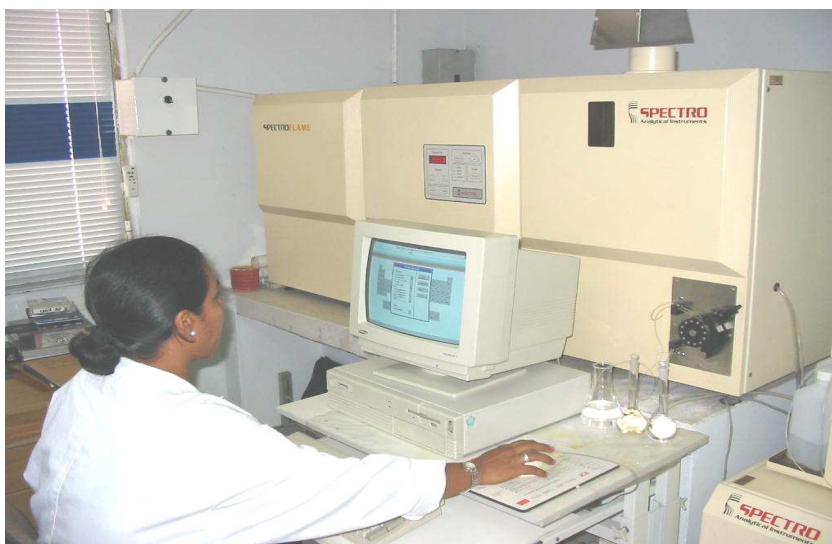
Equipo de emisión atómica ICP, Spectro Flame Modula, utilizado para la determinación de metales pesados
