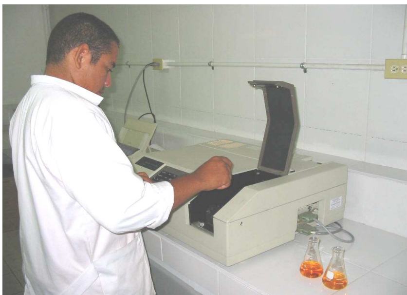
Espectrofotómetro UV-VIS Perkin Elmer-Lambda 12, utilizado en la determinación de nutrientes en muestras ambientales
