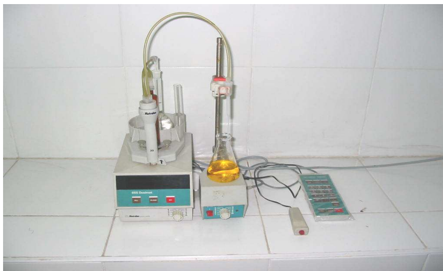
Bureta digital – automática utilizada para la determinación de oxígeno disuelto por el Método Winkler
