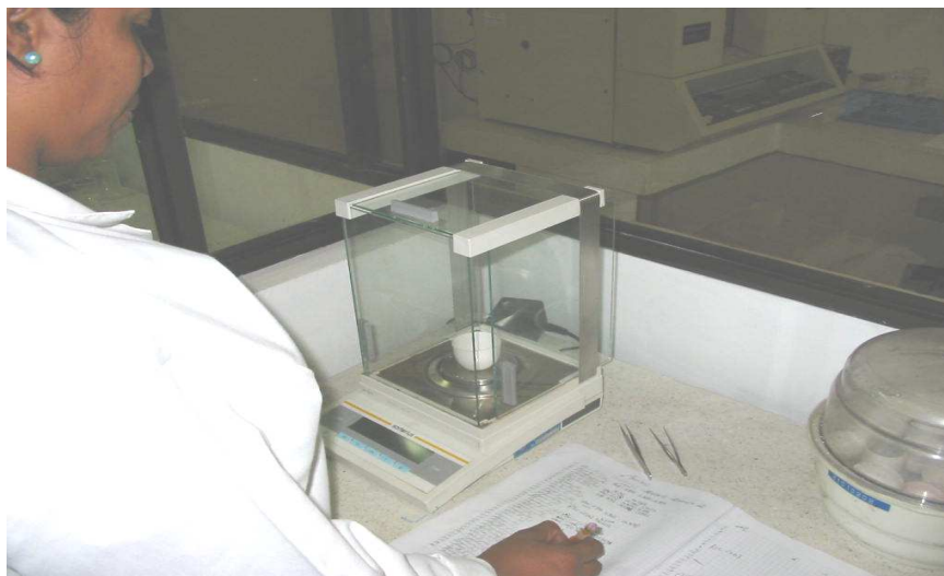
Balanza analítica empleada para la determinación de sólidos en muestras de agua
