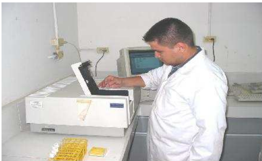
Espectrofluorómetro Shimadzu 5301-PC utilizado para la determinación de Hidrocarburos Aromáticos Totales (HAT)
